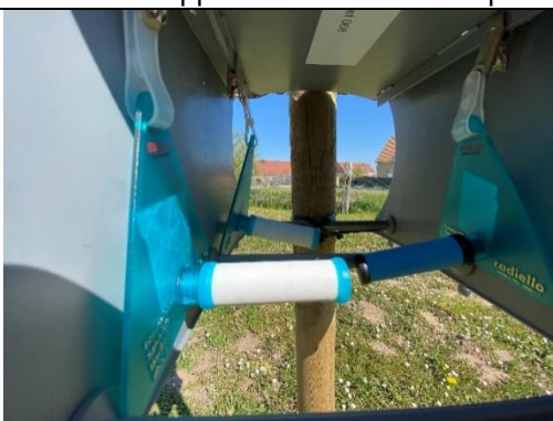
Tubes « Radiello » fixés sur le support à l'abri des intempéries (H 2 S, NH 3 et COV)
