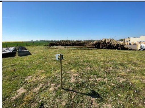
Tubes « Radiello » fixés sur le support à l'abri des intempéries (H 2 S, NH 3 et COV)
