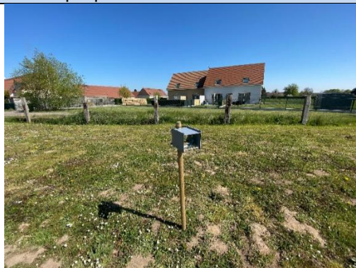
Tubes « Radiello » fixés sur le support à l'abri des intempéries (H 2 S, NH 3 et COV)
