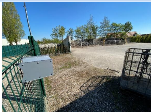
Tubes « Radiello » fixés sur le support à l'abri des intempéries (H 2 S, NH 3 et COV)
