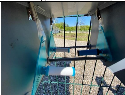
Tubes « Radiello » fixés sur le support à l'abri des intempéries (H 2 S, NH 3 et COV)
